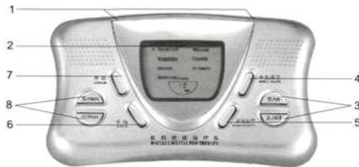
1. Ein- und Ausgang (2x): um das Stromkabel anzuschließen;
